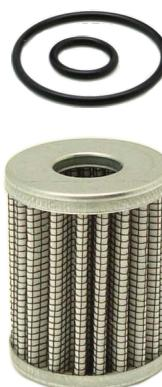
■ Clase 1. Equipo de filtración GLP fase líquida, de uso repetido, cartucho fibra de vidrio reemplazable (CF-115-2). Cuerpo con orificios de entrada y salida para un tubo de cobre D=6 mm (M10x1) ó D=8 mm (M12x1)
