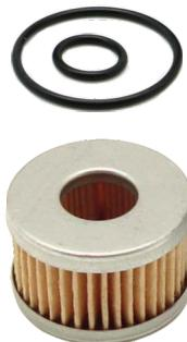
■ Clase 1. Equipo de filtración GLP fase líquida, de uso repetido, cartucho papel (secante) reemplazable (CF-101-Z). Cuerpo con orificios de entrada y salida para un tubo de cobre D=6 mm (M 10 x 1) (Código del producto: 0345701/10) ó D=8 mm (M 12 x 1) (Código del producto: 0345701/12). Aleación zinc-aluminio.
