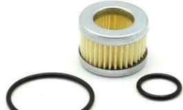
■ Clase 1. Equipo de filtración GLP fase líquida, de uso repetido, cartucho papel (secante) reemplazable (CF-105). Cuerpo con orificios de entrada y salida para un tubo de cobre D=6 mm (M 10 x 1) (Código del producto: 0345702/10) ó D=8 mm (M 12 x 1) (Código del producto: 0345702/12 ). Aleación aluminio.
