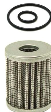
Classe 1; Ensemble de filtration GPL en phase liquide, réutilisable, catrouche en fibre de verre(CF-115-2). Il a les raccordements d'admission et de sortie pour le tube en acier D=6 mm (M10x1) ou D=8mm (M12x1). Il y a aussi une version avec les raccords pour tuyau thermoplastique.
