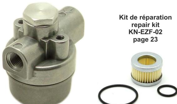
Classe 1; Ensemble de filtration GPL en phase liquide, réutilisable, cartouche en papier (CF-105). Il a les raccordements d'admission et de sortie pour le tube en acier D=6 mm (M10x1) (Code du produit: 0345702/M10) ou D=8mm (M12x1) (Code du produit: 0345702/M12). Le filtre est d'aluminium.
