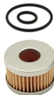
Classe 1; Ensemble de filtration GPL en phase liquide, réutilisable, catrouche en papier échangeable(CF-101-Z). Il a les raccordements d'admission et de sortie pour le tube en acier D=6 mm (M10x1) (Code du produit: 0345701/10) ou D=8mm (M12x1)(Code du produit: 0345701/12). Alliage de zinc et d'alluminium enduit de revêtement galvanique. Température du travail: de -20°C à120°C. Pression de classification: 3000kPa.
